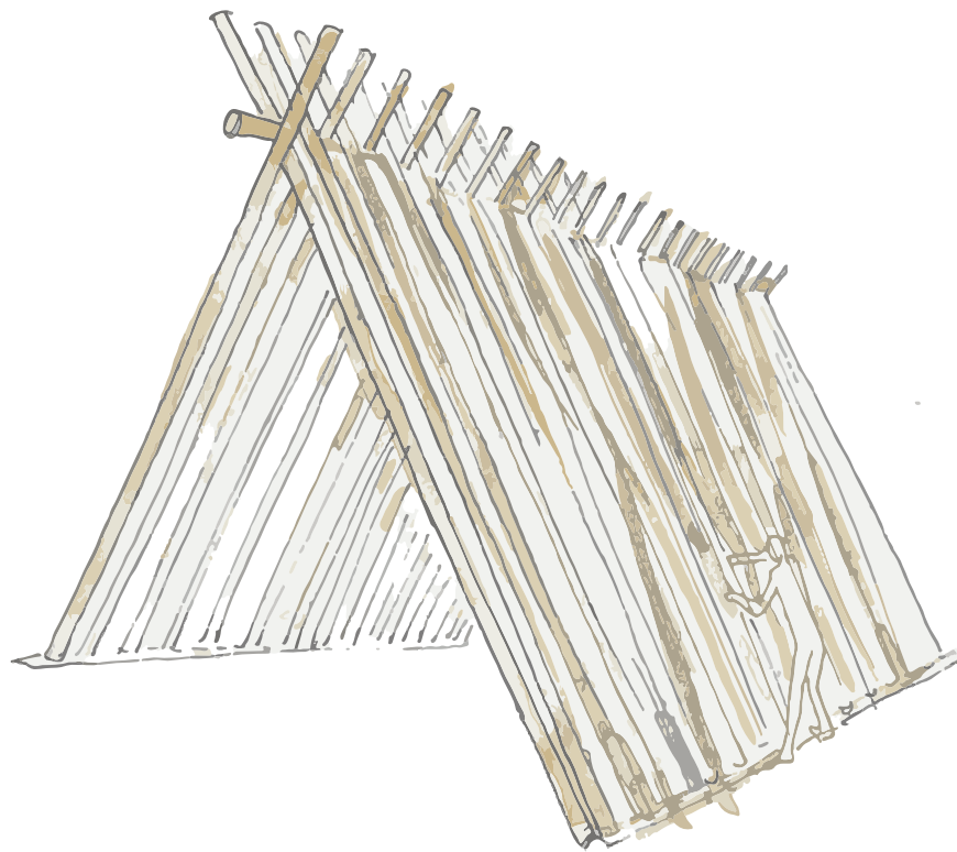
Figura 8. Blanqueamiento del bambú sobre el "burro".
