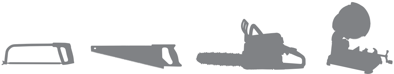
Figura 17. Herramientas de corte: Arco con segueta, serrucho, motosierra y cortadora de metales
