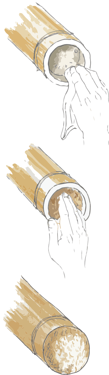
Figura 59. Proceso para sellar extremos
