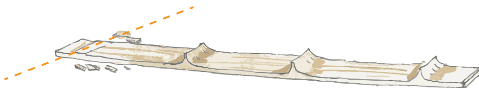
Figura 46. Retirar nudos internos de latas.
