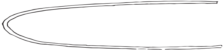
Figura 42. Dobles de varilla corrugada.
